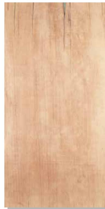
幅の方向のりょう線から200mm離れた個所における開口した割れで最大幅13.0mmのもの1個
