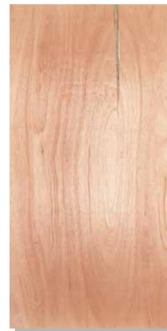
幅の方向のりょう線から200mm離れた個所における開口した割れで最大幅23.0mmのもの1個
