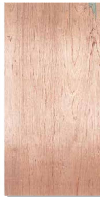
幅の方向のりょう線から200mm以内の開口した割れ60.0mmのもの1個
