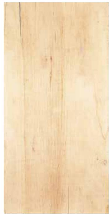
長さが板長の40%以下で、割れ幅が6.0mm以下のものが2個穴は5.0mm以下のもの1個
