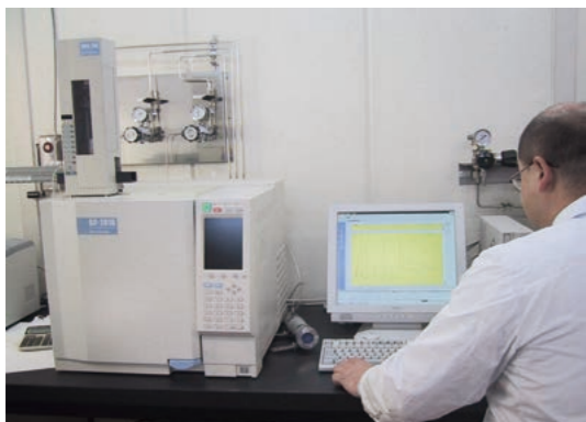
ガスクロマトグラフ質量分析機器 空気中の揮発性物質をごく微量であっても抽出して濃度を分析することができます。
