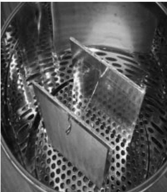
写真2．試験片設置状況 (小形チャンバー法)
